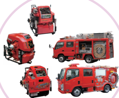
動力消防ポンプ
