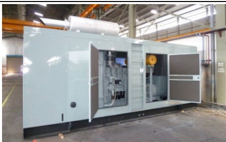
キュービクル式自家発電設備（工場完成品）
